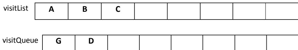
Gambar 31.5 Langkah 4 Algoritma Traversal Graph : BFS
