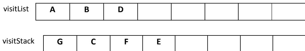
Gambar 31.13 Langkah 4 Algoritma Traversal Graph : DFS
